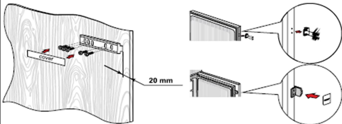
**7.** Установите крышку петли в следующем положении.
